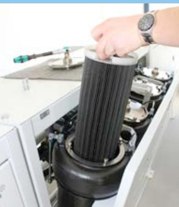
Le cartucce filtranti vengono risciacquate periodicamente in corrispondenza del processo. In caso di usura è facilissimo sostituirle rapidamente.
