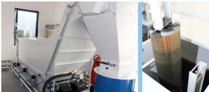
C'est le concentrateur automatique AK50 qui se charge de la récupération en bon état des fins copeaux de carbure. Le concentrateur automatique AK50 comporte également des cartouches filtrantes MicroPur® qui font l'objet d'un rétro rinçage automatique.
