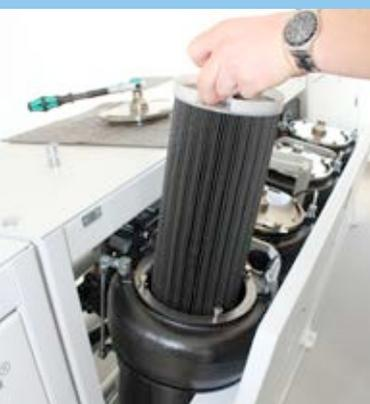
Les cartouches filtrantes font l'objet à intervalles réguliers d'un rétroinçage se déroulant en parallèle avec le processus. Une fois usées, celles-ci se remplacent facilement, proprement et en très peu de temps.
