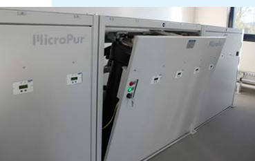
Für die neue Werkzeugschleiferei hat HAIMER in eine zentrale KSS-Reinigung von KNOLL Maschinenbau investiert, die als Kernelement den Feinstfilter MicroPur® enthält.
