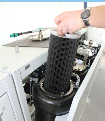
Die Filterpatronen werden regelmäßig prozessparallel rückgespült. Bei Verschleiß lassen sie sich einfach, sauber und in kürzester Zeit austauschen.
