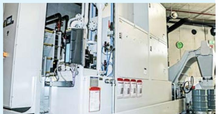
Beste Erfahrungen hat Ceratizit Austria mit KNOLL MicroPur®-Zentralanlagen zur Ölreinigung gemacht. Die Filterfeinheit liegt bei 1 µm, und der gravimetrische Restschmutzgehalt sank von 100 mg/l auf nur noch 1 mg/l.
