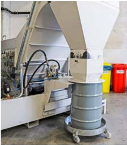
Wichtiger Bestandteil der KNOLL Filteranlagen ist der integrierte, automatische Abschlammkonzentrator, der dafür sorgt, dass der Hartmetallschlamm stichfest im Entsorgungsfass landet.
