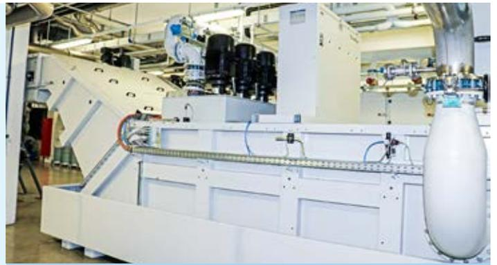
Zentrale Reinigungsanlage für wässrige Lösung: KNOLL kombiniert Hydrozyklone und MicroPur®-Filter (oben im Vordergrund), um bei Ceratizit Austria insgesamt 40 Spitzenlosschleif- und Trennmaschinen mit 3.500 l/min gereinigter wässriger Lösung zu versorgen.
