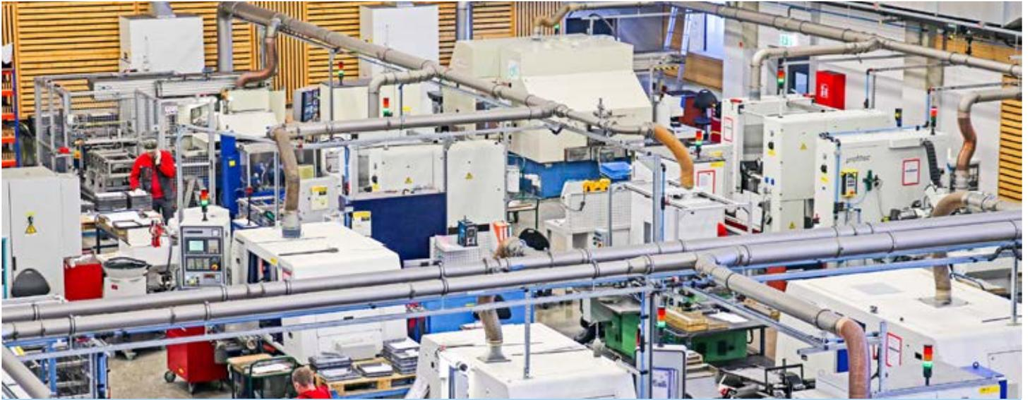
Blick in eine Fertigungshalle bei Ceratizit Austria, in der HM-Wendeschneidplatten geschliffen werden. Für deren geforderte hohe Qualität ist die Feinstreinigung des Schleiföls unerlässlich.
