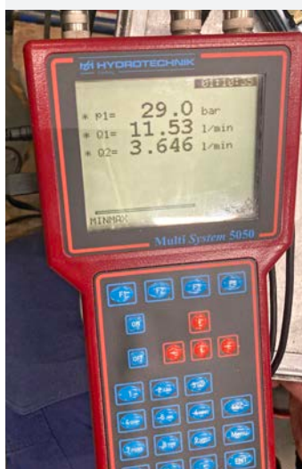
Dispositivo di misurazione della pressione e del volume del lubrorefrigerante richiesto.
