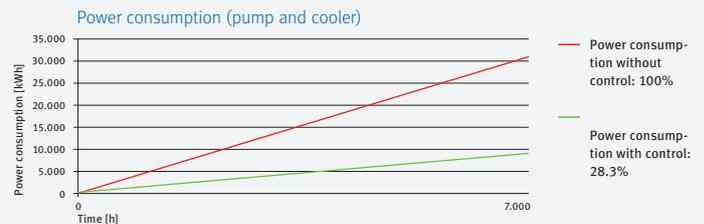
El control de frecuencia reduce el consumo de energía de la bomba y el refrigerador en un 28,3 %.
