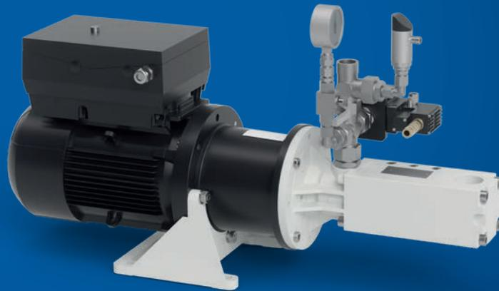
*Junto con el equipo de gestión energética de Bosch Power Solutions (Homburg, Alemania), KNOLL Maschinenbau (Bad Saulgau, Alemania) transformó las líneas de producción de una fábrica de motores. Se vieron afectadas las bombas de alta presión de casi 50 centros de mecanizado. Se equiparon con convertidores de frecuencia y ahora suministran a las máquinas el lubricante refrigerante en función de las necesidades. El ahorro medio de energía es superior al 50 %.*
