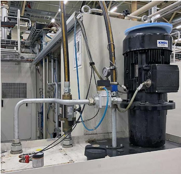
KNOLL instaló una bomba de alta presión KTS en un centro de mecanizado: si hay que suministrar lubricante refrigerante a alta presión durante el mecanizado, las bombas de alta presión controladas por frecuencia abren un gran potencial de ahorro.
