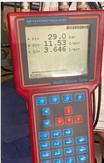
Messgerät für Druck und Volumen des benötigten KSS.
