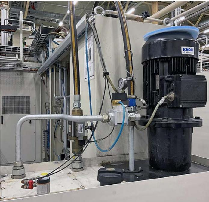
An einem Bearbeitungszentrum installierte KNOLL eine Hochdruckpumpe KTS: Wenn bei der Zerspangung Kühlschmierstoff unter hohem Druck zugeführt werden muss, eröffnen frequenzgesteuerte Hochdruckpumpen große Einsparmöglichkeiten.
