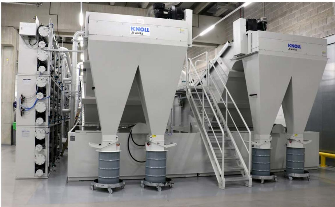
Installation centrale de nettoyage pour solution aqueuse : les points forts du système MicroPur® se montrent déjà au niveau de la surface d'installation. Il n'occupe en effet que 60 % de la place requise par une installation de filtration conventionnelle de même débit.
