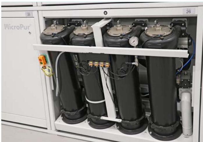
Los módulos MicroPur® están equipados con cuatro cuerpos del filtro, cada uno de los cuales contiene dos cartuchos filtrantes. La capacidad de limpieza por módulo es de 400 l/min.
