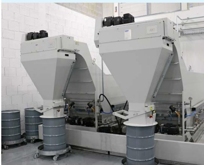
Un componente importante de las instalaciones de filtraje KNOLL es el concentrador automático integrado, que garantiza que el lodo de metales duros acabe en el bidón de eliminación a prueba de pinchazos.
