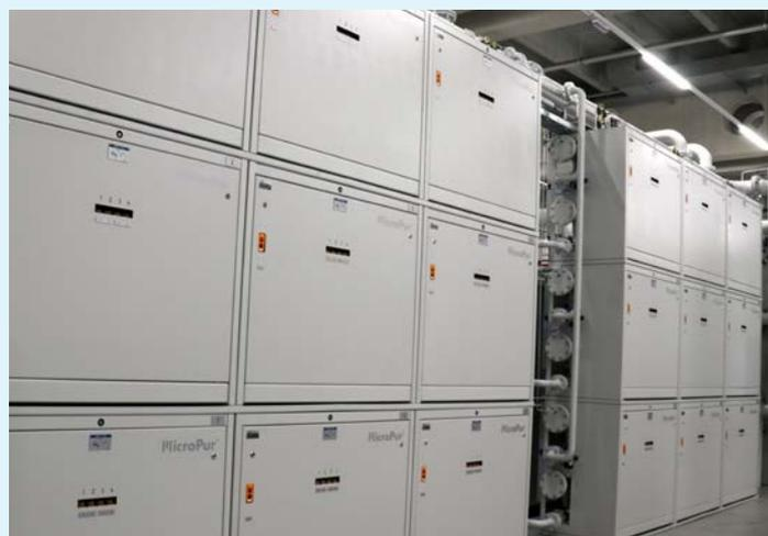
Gracias a su diseño modular, las instalaciones de limpieza centrales de lubricantes refrigerantes con filtros MicroPur® pueden realizarse en casi cualquier tamaño. Esta instalación para soluciones acuosas ofrece una capacidad de limpieza de hasta 7500 l/min de lubricante refrigerante.
