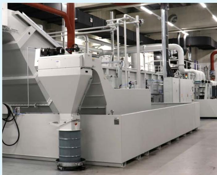
Perspectiva de crecimiento: la instalación MicroPur® de KNOLL para la filtración de aceite puede ampliarse hasta una capacidad de 10 000 l/min.
