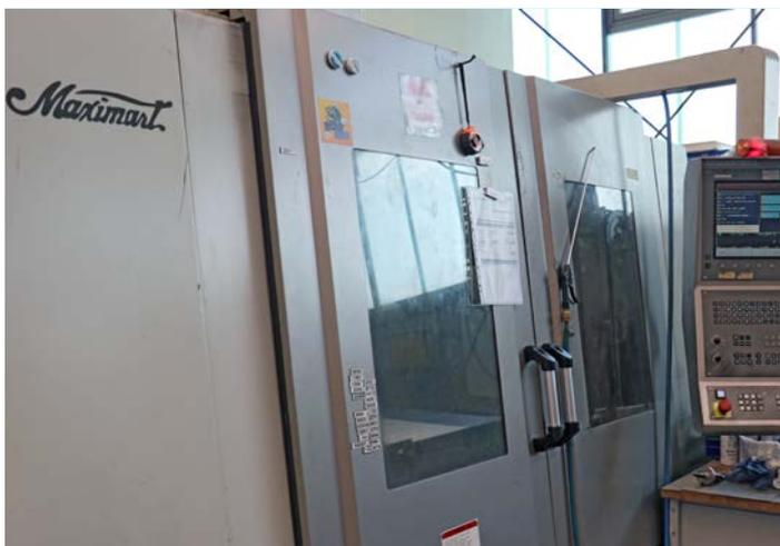
Extrêmement productif, même à un âge avancé : Julian Wiegold a équipé le centre d'usinage Maximart VMC 105, construit en 2004, d'un système de serrage à vide et du KNOLL Aerosol-Master. Il fournit une puissance maximale lors de l'usinage de plaques aluminium.
