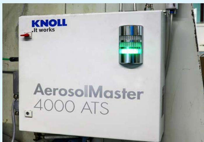
La particularité de la lubrification à sec en aérosol est qu'un aérosol fin doté d'une taille de goutte moyenne de 0,25 µm est généré. Pour cette raison, même à des régimes élevés et sur de longues distances, une séparation de l'aérosol est peu probable.
