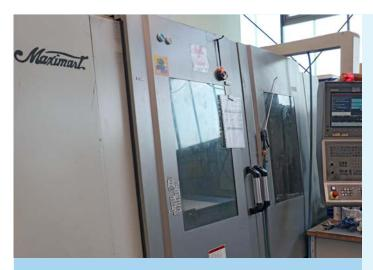
Extremadamente productivo incluso en máquinas antiguas: Julian Wiegold modernizó el centro de mecanizado Maximart VMC 105, construido en 2004, con un sistema de sujeción por vacío y el AerosolMaster de KNOLL. Ahora, esta máquina ofrece el máximo rendimiento en el mecanizado de placas de aluminio.
