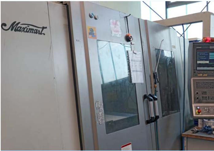
Auch im Alter äußerst produktiv: Julian Wiegold rüstete das Bearbeitungszentrum Maximart VMC 105, Baujahr 2004, mit Vakuumpansystem und KNOLL AerosolMaster auf. Beim Bearbeiten von Aluminiumplatten bringt sie nun Höchstleistungen.
