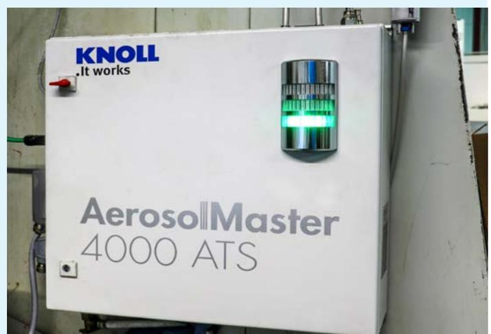
Die Besonderheit der AerosolTrockenschmierung ist, dass feines Aerosol mit einer durchschnittlichen Tröpfchengröße von 0,25 µm erzeugt wird. Deshalb ist selbst bei hohen Drehzahlen und auf langen Distanzen eine Entmischung des Aerosols kaum zu erwarten.
