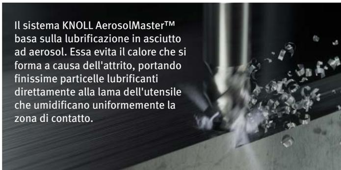
Il sistema KNOLL AerosolMaster™ basa sulla lubrificazione in asciutto ad aerosol. Essa evita il calore che si forma a causa dell'attrito, portando finissime particelle lubrificanti direttamente alla lama dell'utensile che umidificano uniformemente la zona di contatto.
