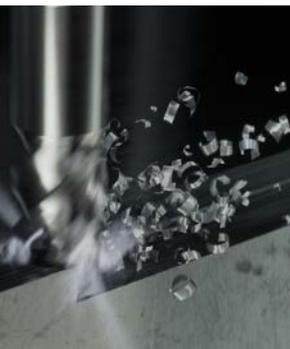
Durch die Aerosol-Trockenschmierung lassen sich Produktivitätssteigerungen in Form höherer Schnittwerte bzw. längerer Werkzeugstandzeiten erreichen.
