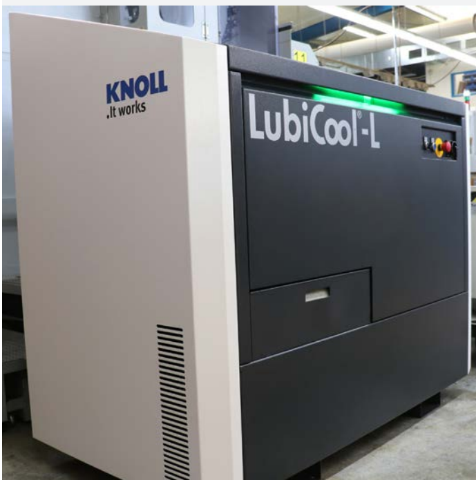
Il KNOLL LubiCool®-L è l'unità compatta ad alta pressione più potente e versatile di KNOLL. È predestinata per piccoli e medi centri di lavorazione nonché torni, che sono alimentati ad alta e bassa pressione.
