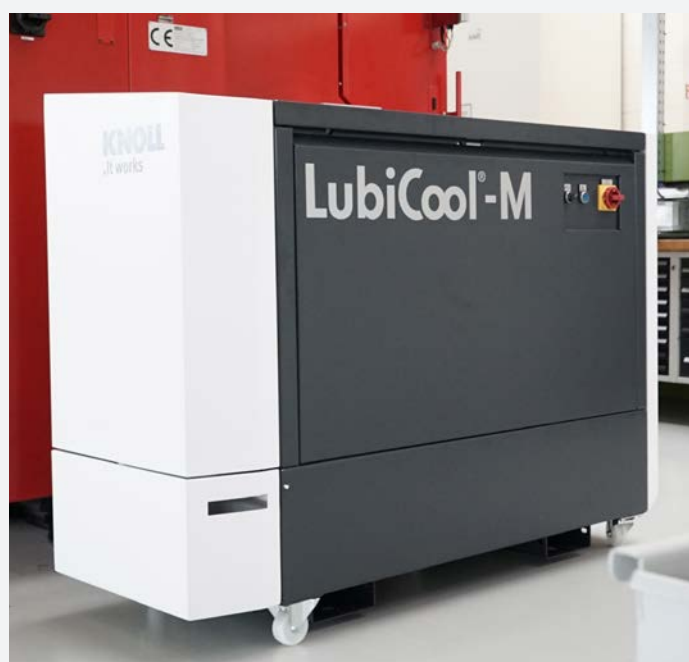
La station haute pression mobile KNOLL LubiCool®-M génère une pression de lubrifiant réfrigérant jusqu'à 150 bars et un débit volumique jusqu'à 27 l/min.
