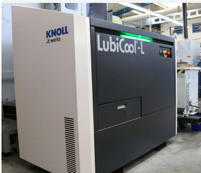
Le KNOLL LubiCool®-L est la plus puissante et la plus polyvalente des unités haute pression compactes de KNOLL. Il convient aux centres d'usinage de petite et moyenne taille ainsi qu'aux tours dont il assure l'alimentation sous haute et basse pression.
