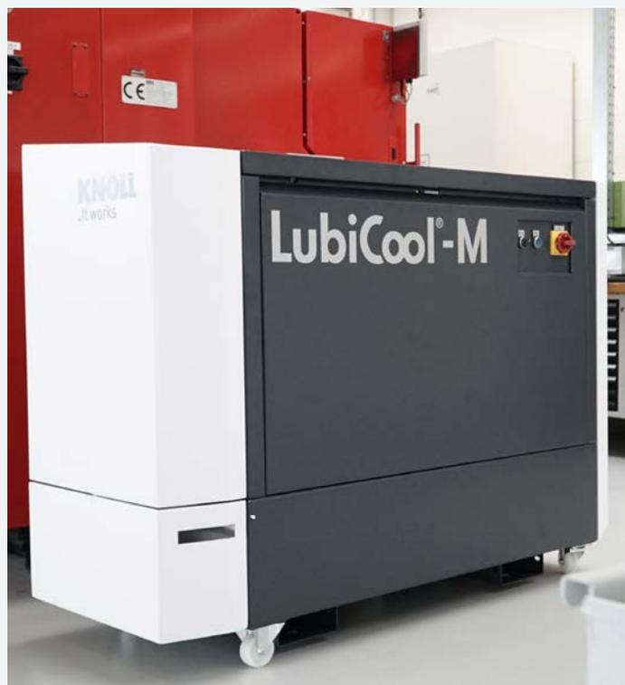
La estación móvil de alta presión KNOLL LubiCool®-M genera una presión de lubricante refrigerante de hasta 150 bares y un caudal de hasta 27 l/min.
