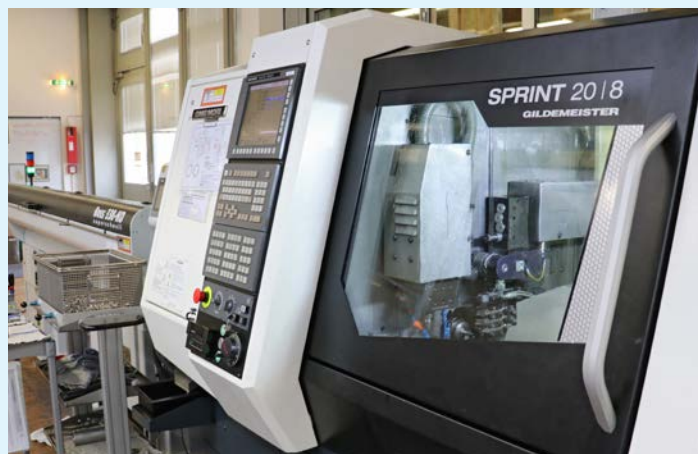
Lo Sprint 20 di DMG MORI impiegato come tornio corto: con questa macchina l'ifm produce adattatori per la sensoristica per fluidi nell'esercizio a tre turni.
