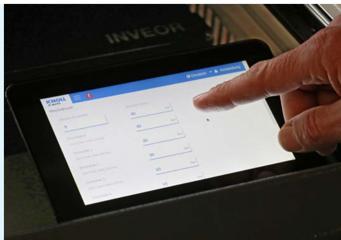
Un highlight dell'intera serie LubiCool® è il comando assolutamente facile, intuitivo. A questo scopo KNOLL sviluppò il nuovo concetto di controllo „SmartConnect“ che contiene un piccolo touch display, attraverso il quale l'utente è in grado di regolare lo stadio di pressione desiderato e altri parametri.
