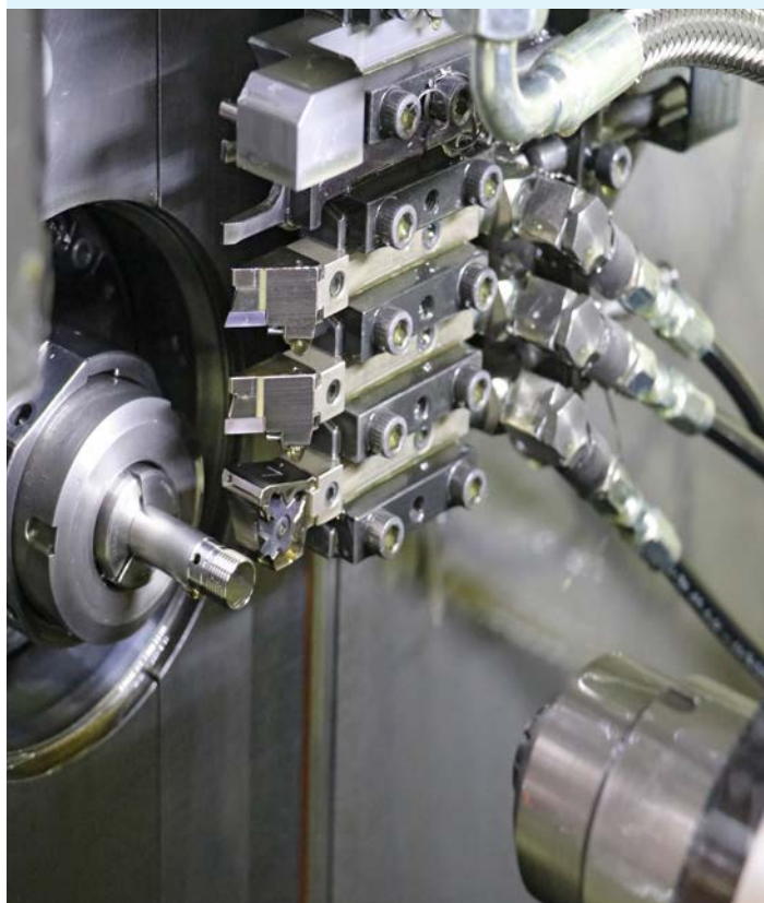
Nell'aggregato ad alta pressione KNOLL LubiCool®-S fino ad otto uscite attivabili provvedono all'alimentazione della macchina utensili a seconda delle esigenze con lubrorefrigerante – qui la DMG MORI Sprint 20.
