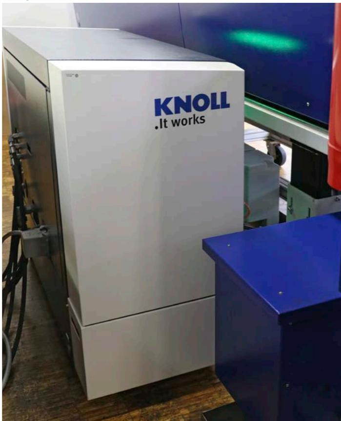
Ce LubiCool®-M de KNOLL alimente un tour à poupée mobile en haute pression. En outre, il nettoie le lubrifiant réfrigérant provenant de la machine-outil au moyen d'un non-tissé filtrant et élimine immédiatement l'encrassement du circuit. Ainsi, le LubiCool®-M empêche de manière extrêmement efficace la concentration de particules fines dans l'ensemble du fluide.
