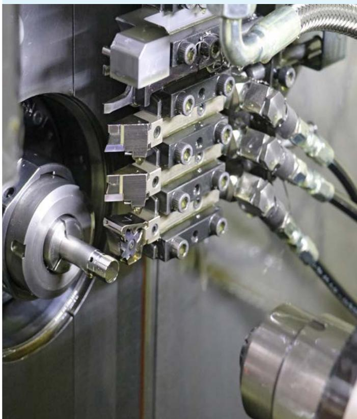
Sur l'appareil haute pression LubiCool®-S de KNOLL, jusqu'à huit sorties commutables assurent que la machine-outil – ici la Sprint 20 de DMG MORI – soit alimentée en lubrifiant réfrigérant selon les besoins.
