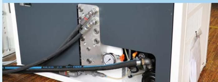
LubiCool®-S vu de derrière : KNOLL fournit l'installation à haute pression en version plug-and-play – avec pack de flexibles, accessoires et interface spécifique à la machine.
