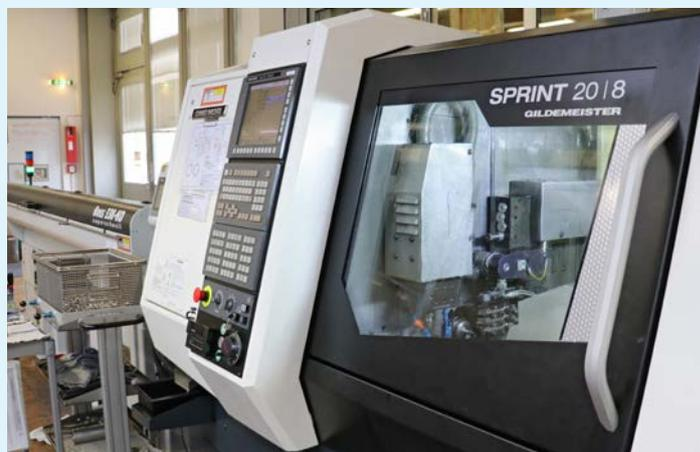
La Sprint 20 de DMG MORI utilisée comme tour à poupée fixe : ifm produit avec cette machine des adaptateurs pour les capteurs de fluide en exploitation à trois équipes.
