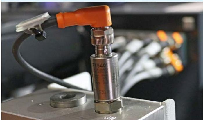
Partenariat entre ifm et KNOLL Maschinenbau : KNOLL utilise, sur tous les appareils LubiCool®, des capteurs de fluide provenant de l'entreprise ifm, par exemple le transmetteur de pression PT que l'on voit sur la photo...
