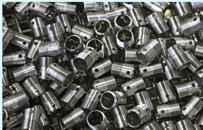
Les adaptateurs fabriqués sur la Sprint 20 de DMG MORI contiennent un filet extérieur, des encoches et un trou transversal.
