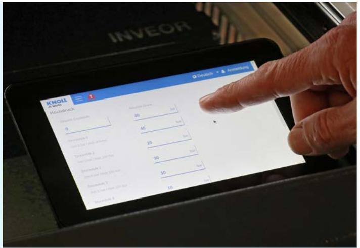
Ein Highlight der gesamten LubiCool®-Baureihe ist die völlig unkomplizierte, intuitive Bedienung. Hierfür entwickelte KNOLL das neue Steuerungskonzept „SmartConnect“, das ein kleines Touchdisplay enthält, über das der Anwender die gewünschte Druckstufe und andere Parameter einstellen kann.
