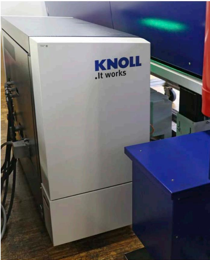
Dieser KNOLL LubiCool®-M versorgt einen Langdrehautomaten mit Hochdruck. Außerdem reinigt er den aus der Werkzeugmaschine stammenden KSS mittels Filtevlies und entfernt die Schmutzlast direkt aus dem Kreislauf. Der LubiCool®-M verhindert somit äußerst effektiv die Aufkonzentration von Feinstpartikeln im gesamten Medium.
