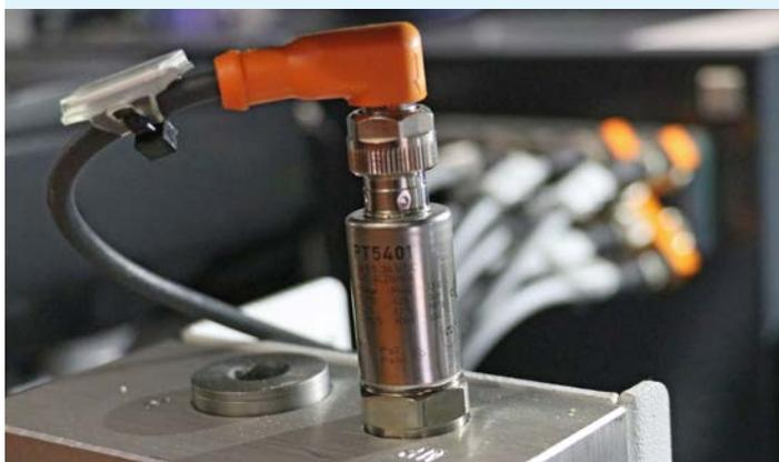
Gegenseitige Partnerschaft zwischen ifm und KNOLL Maschinenbau: So setzt KNOLL bei allen LubiCool®-Geräten Fluidsensoren aus dem Hause ifm ein, zum Beispiel den im Bild zu sehenden PT-Drucktransmitter ...
