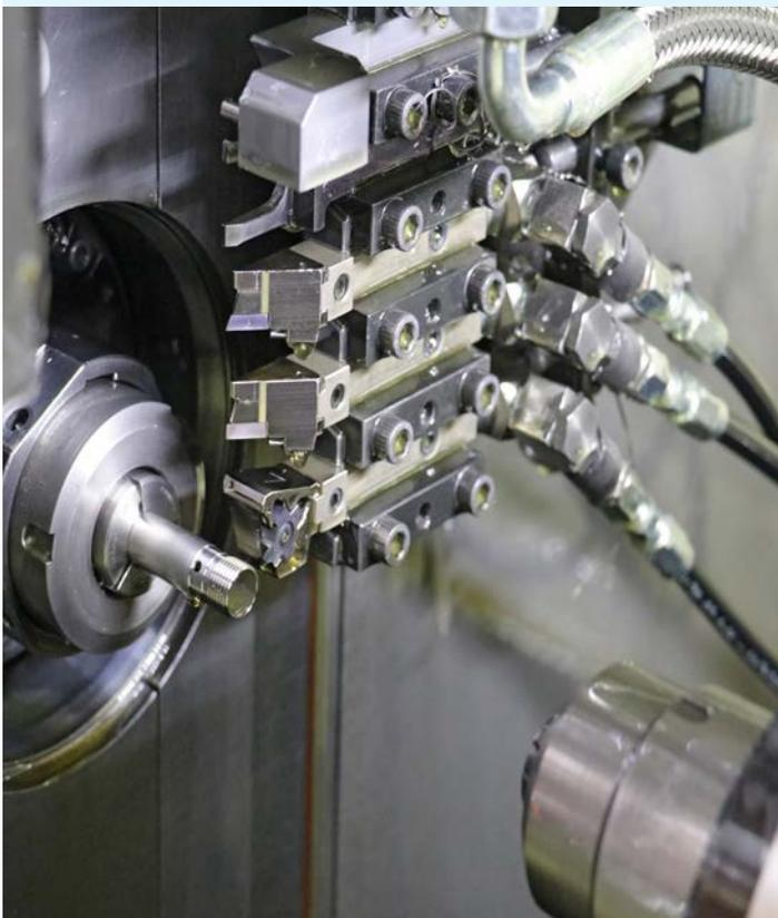
Bis zu acht schaltbare Ausgänge sorgen beim KNOLL Hochdruckgerät LubiCool®-S dafür, dass die Werkzeugmaschine – hier die DMG MORI Sprint 20 – bedarfsgerecht mit Kühlschmierstoff versorgt wird.
