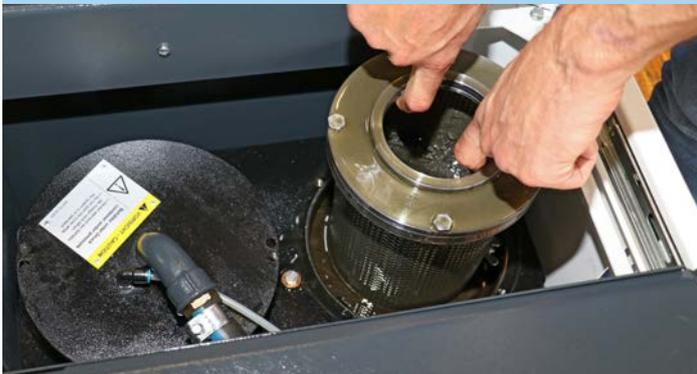
Beim KNOLL LubiCool®-S lässt sich das Filterelement ganz einfach und in nur fünf Minuten wechseln. Bei ifm in der Hülsenfertigung ist dies trotz Drei-Schicht-Betrieb des Kurzdrehautomaten nur alle sechs Wochen erforderlich.
