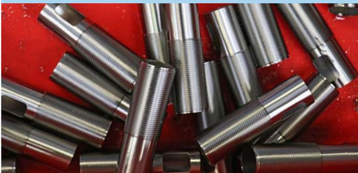
Hülsen mit M18-Gewinde, die auf dem mit KNOLL LubiCool®-M ausgestatteten Langdrehautomaten gefertigt wurden.
