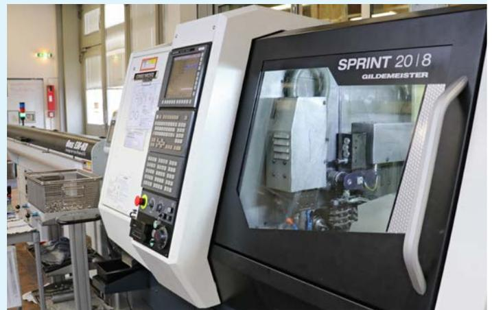
Die als Kurzdreher eingesetzte Sprint 20 von DMG MORI: ifm produziert mit dieser Maschine im Drei-Schicht-Betrieb Adapterstücke für die Fluidsensorik.
