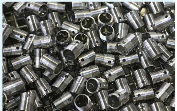
Die auf der DMG MORI Sprint 20 gefertigten Adapterstücke enthalten ein Außengewinde, Einstiche und eine Querbohrung.
