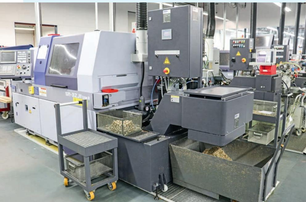
Depuis déjà des années, Gerland fait équiper par KNOLL divers centres de tournage d'une combinaison fixe composée d'un convoyeur de copeaux, d'un système de filtrage et d'une installation à haute pression.
