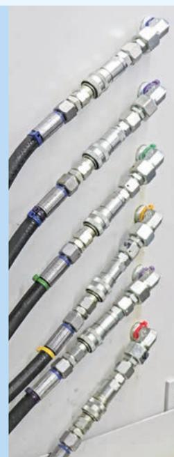
Der Anschluss des LubiCool®-M-Geräts funktioniert nach dem Plug-and-Play-Prinzip über sechs standardisierte Schlauchkupplungen.
