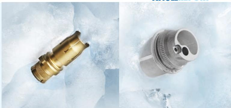
Ein für Gerland typisches Bauteil für die Automatisierungstechnik aus Messing (links) sowie eines aus einer speziellen Aluminiumlegierung (rechts). Die Bearbeitung erfordert eine stabile Maschinenausführung. Die KSS-Versorgung mit über 80 bar erhöht dabei die Oberflächengüte und Standzeit erheblich
