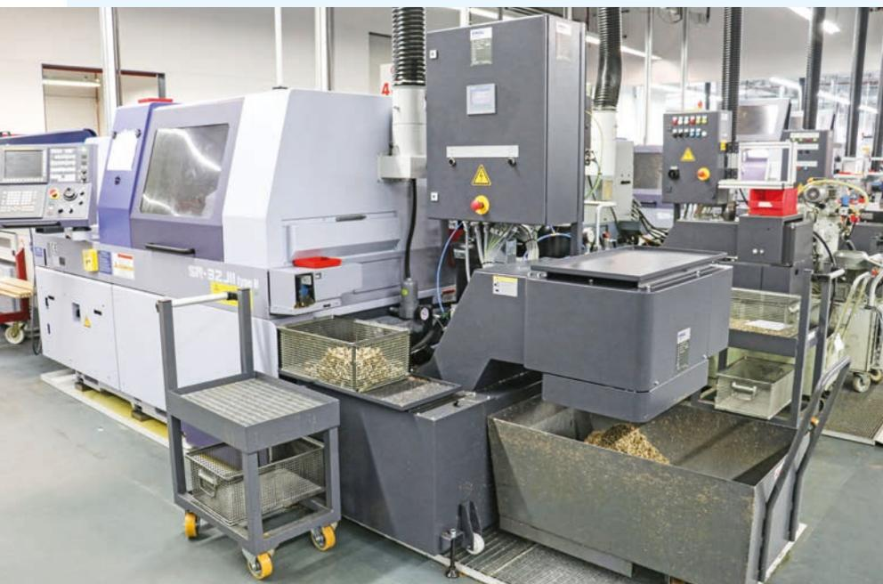
Gerland lässt von KNOLL schon seit Jahren diverse Drehautomaten mit einer fest installierten Kombination aus Späneförderer, Filter- und Hochdruckanlage ausstatten.
