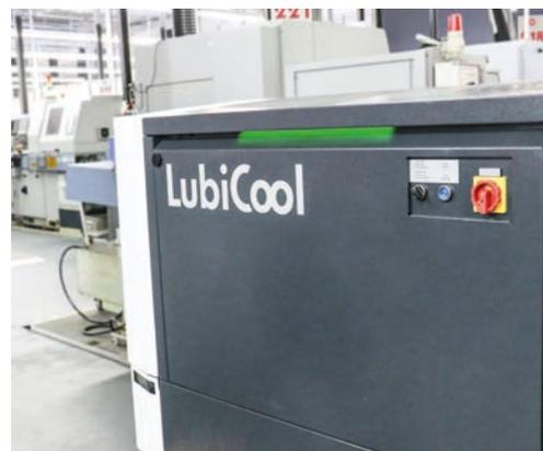
KNOLL Maschinenbau hat sein großes Know-how bezüglich der Hochdruck-KSS-Versorgung von Drehautomaten in das mobile Aggregat LubiCool® gepackt.
