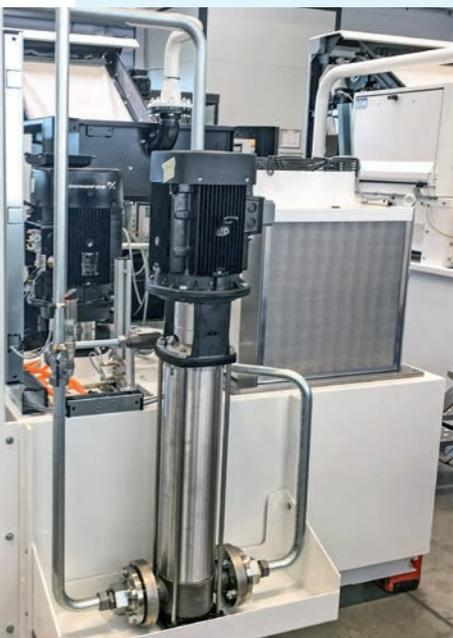
Costruzione modulare: una console con pompa ad alta pressione può essere montata in qualsiasi momento.
