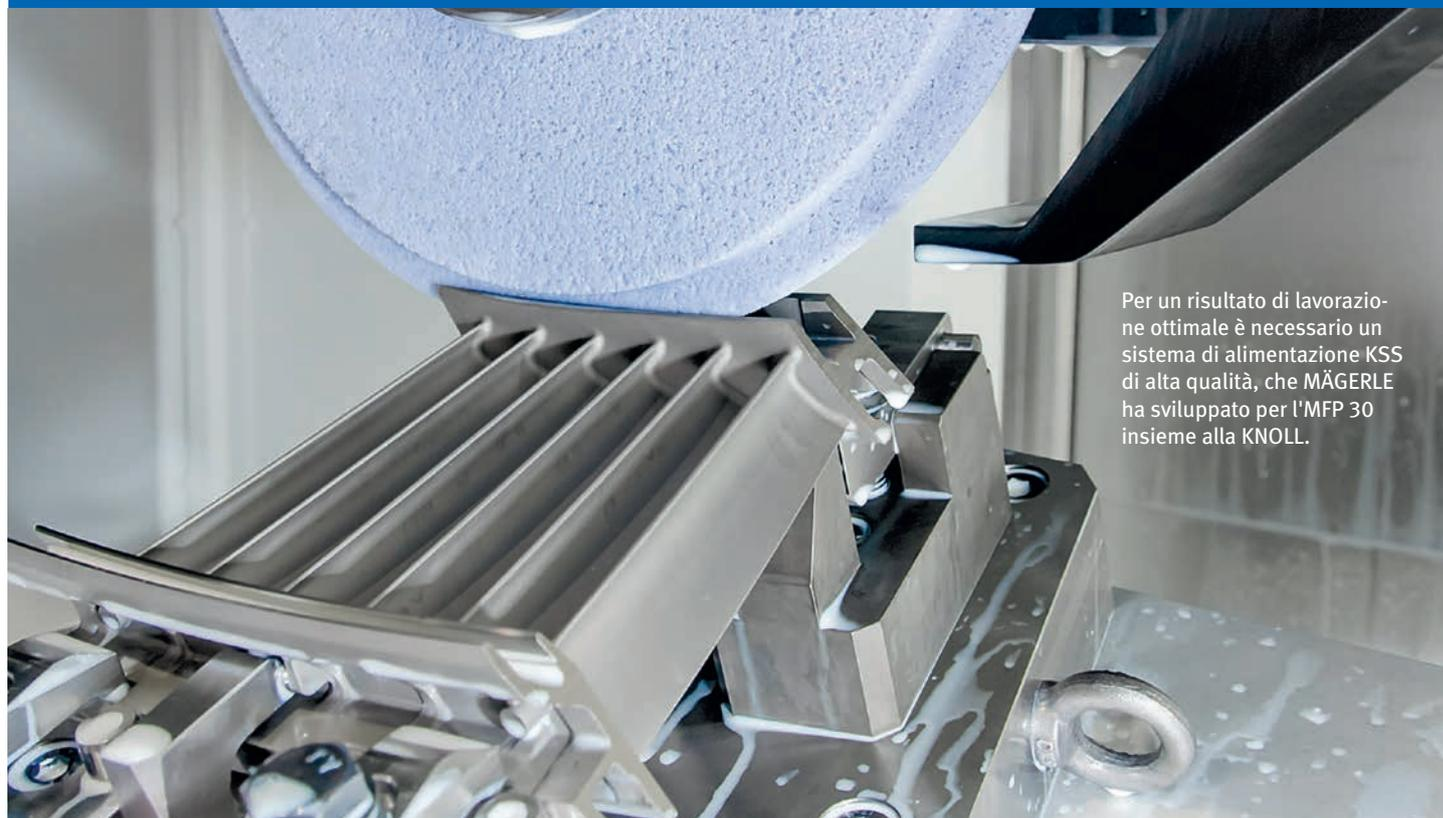
Per un risultato di lavorazione ottimale è necessario un sistema di alimentazione KSS di alta qualità, che MÄGERLE ha sviluppato per l'MFP 30 insieme alla KNOLL.
