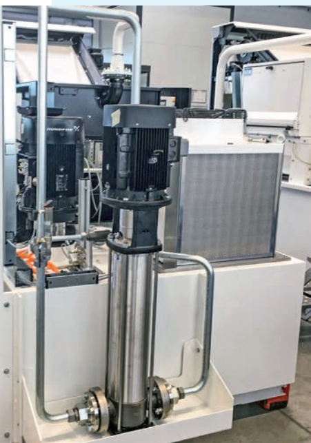
Modularer Aufbau: Eine Konsole mit Hochdruckpumpe ist jederzeit nachrüstbar.
