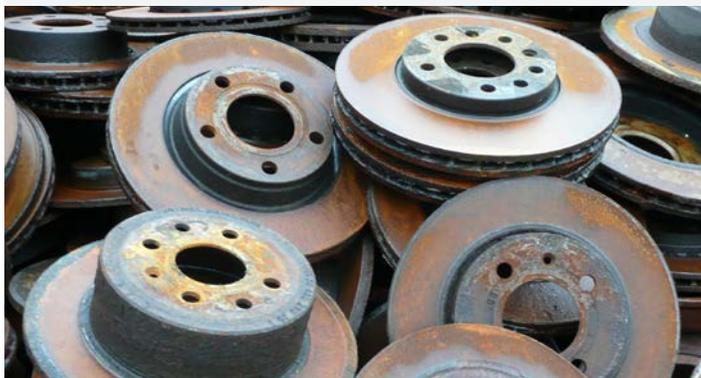
Mit Einführung der Euro 7-Norm gehören solche Bremsscheiben der Vergangenheit an. Voraussichtlich werden in Zukunft beschichtete Bremsscheiben dominieren, die bevorzugt mit wässrigen Lösungen geschliffen werden.
