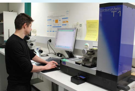
Mit hochgenauen Messgeräten, wie dem taktilen Konturmessgerät QPT Conturo-Matic T1, werden die Teile „auf Herz und Nieren“ geprüft und vor der Auslieferung einer Endkontrolle unterzogen.
