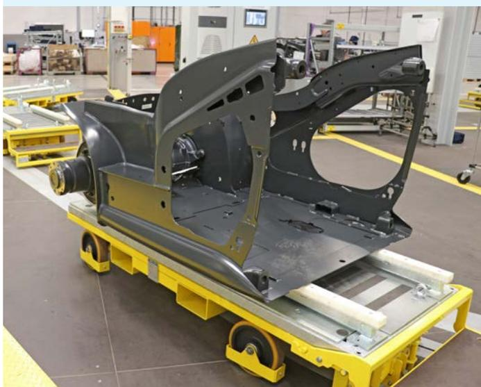
KNOLL ha sviluppato un cosiddetto sistema di sterzo Quattro per i carrelli di montaggio TS-Z, che consente la guida in curva.
