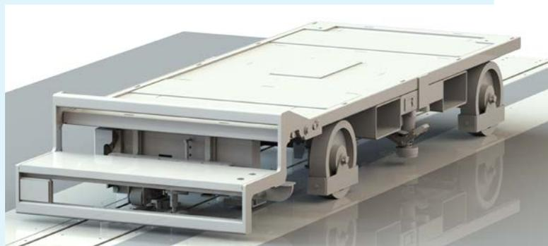
Tramite un'unità di arresto il carrello può essere scollegato o ricollegato in modo controllato dall'azionamento della catena. Inoltre, è possibile un fissaggio della posizione.
