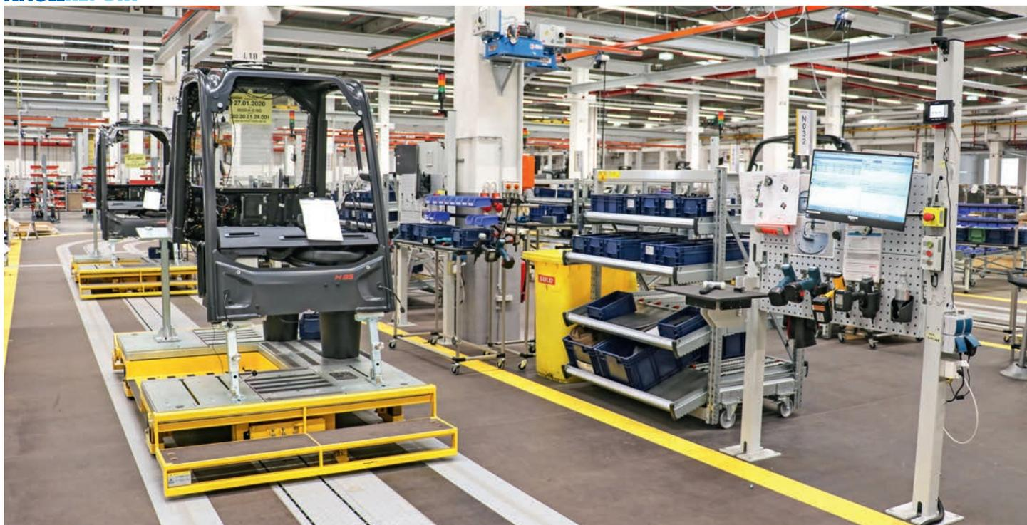
KNOLL ha sviluppato due linee di premontaggio – per il telaio ed il tettuccio di protezione del conducente (nella foto) – per una nuova generazione di carrelli elevatori, in costruzione presso lo "Stabilimento 2" di Linde ad Aschaffenburg.
