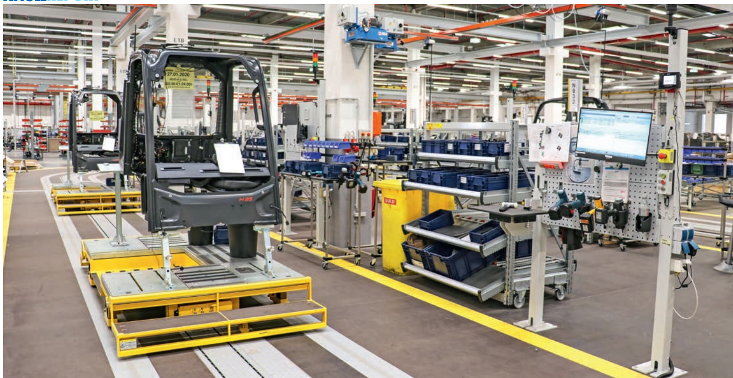
KNOLL desarrolló dos líneas de premontaje para la nueva generación de carretillas elevadoras que se está construyendo en la Planta 2 de Linde, en Aschaffenburg (Alemania); para bastidores y para el techo protector del conductor (en la foto).
