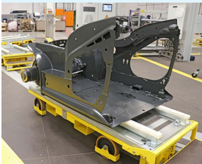
Para los carros de montaje TS-Z, KNOLL desarrolló un sistema de dirección llamado Quattro, que permite el giro en las curvas.
