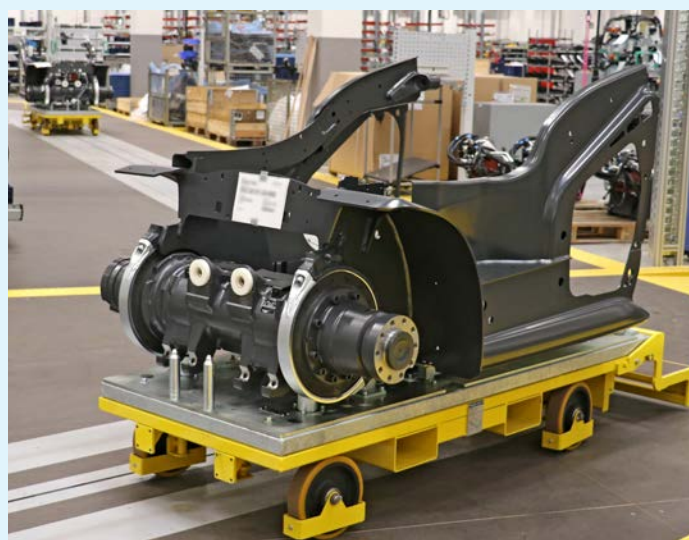
Los conjuntos de bastidores se ensamblan a lo largo de ocho estaciones. Cada estación tiene cinco metros de largo y puede completarse en nueve minutos.
