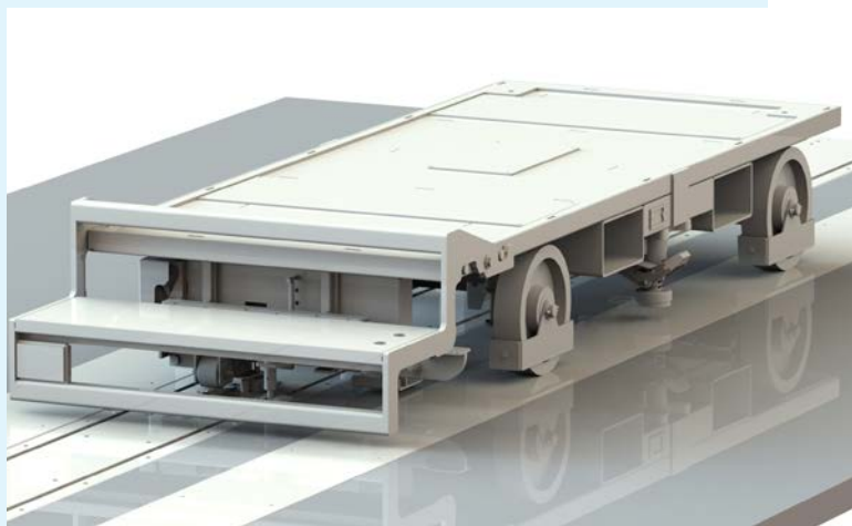
Gracias a una unidad de tope, el carro puede separarse o conectarse del accionamiento de la cadena de forma controlada. Además, es posible fijar la posición del carro.
