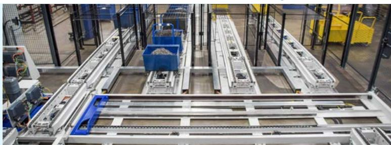
Alla fine dei tragitti tampone i carrelli per trucioli vengono trasportati alle centrifughe tramite un tragitto trasversale.
