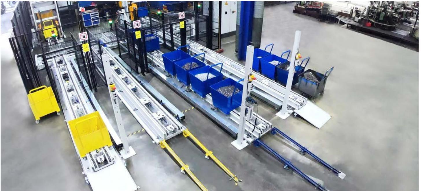
Les centrifugeuses de copeaux sont disposées derrière les systèmes de transport de KNOLL. À partir de là, les copeaux déshuilés sont amenés aux conteneurs vers la droite après être passés par un portique.
