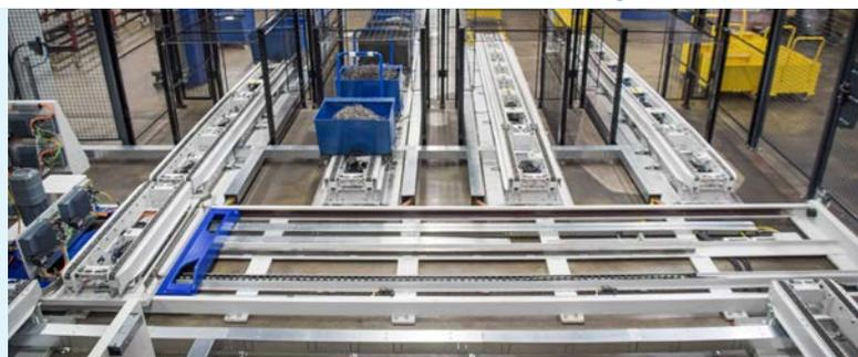
À la fin des voies tampon, les bennes à copeaux sont transportées aux centrifugeuses en passant par une voie transversale.
