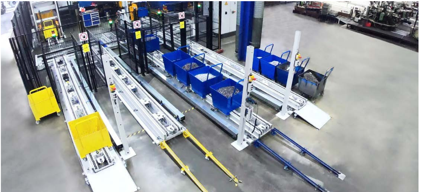
Für eine Staplergeneration, die bei Linde im Aschaffener „Werk 2“ gebaut wird, entwickelte KNOLL zwei Vormontagelinien – für den Rahmen und das Fahrerschutzdach (im Bild).
