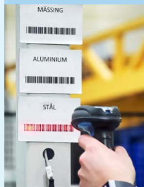
Beim Aufgeben des Spänewagens scannt der Mitarbeiter einen dem Material entsprechenden Barcode.
