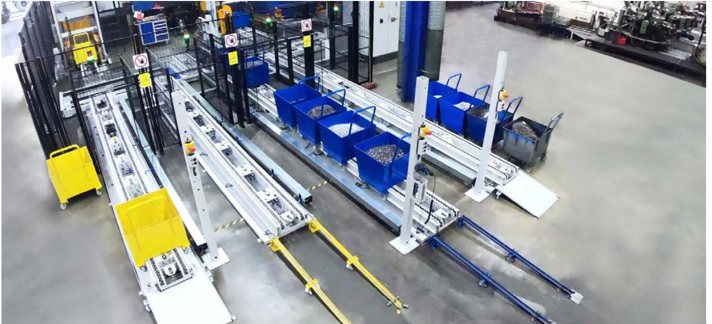
Hinter den KNOLL Transportsystemen sind die Spänezentrifugen angeordnet. Von dort aus werden die entölten Späne über ein Portal nach rechts zu den entsprechenden Containern gebracht.
