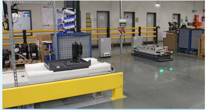
Al final de la primera sección de la línea de transporte se encuentra el punto de transferencia al AGV; a la derecha de la imagen hay dos estaciones de aparcamiento/carga para los AGV.
