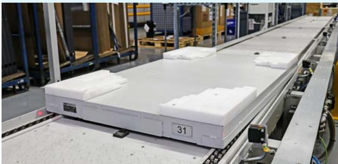
Además de los sistemas de transporte y los puestos de trabajo de montaje, KNOLL también diseñó y suministró las placas de apoyo, que son compatibles con todas las variantes de bombas de calor de STIEBEL ELTRON.
