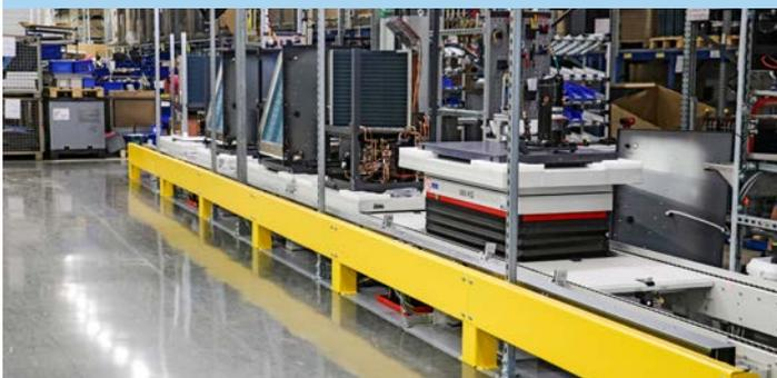
La «línea de evaporadores»: esta línea de transporte incluye dos estaciones de trabajo en las que primero se introduce el evaporador y después se suelda.
