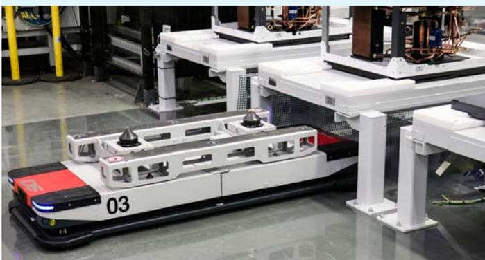
La tecnología de transporte estacionaria se interconecta mediante vehículos de guiado automático. La gestión de pedidos para las órdenes de transporte se realiza en SAP ME, con el cual tiene una interfaz el conjunto de la instalación.
