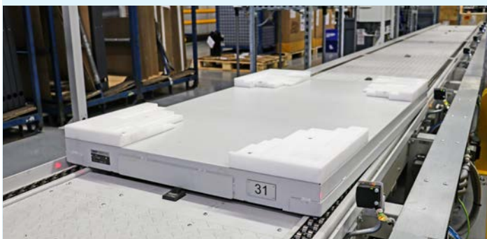
KNOLL konstruierte und lieferte neben den Fördersystemen und Montagearbeitsplätzen auch die Trägerplatten, die mit allen STIEBEL ELTRON Wärmepumpen-Varianten kompatibel sind.
