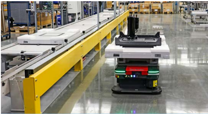
Links im Bild: die erste Förderstrecke. Auf den beiden Montageplätzen werden zunächst die Bodenplatte und dann der Verdichter des jeweiligen Wärmepumpen-Modells montiert.
