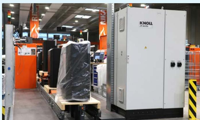
Controllo al 100 percento: all'ultima stazione della linea di montaggio tutti i componenti della stufa sono controllati.
