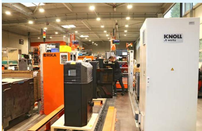
Sensori nella stazione di introduzione riconoscono i relativi corpi di base e trasmettono i dati rilevati al controllo.
