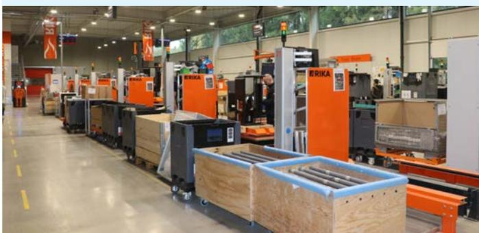
À côté de la ligne, le service logistique met à disposition les composants requis pour le montage.
