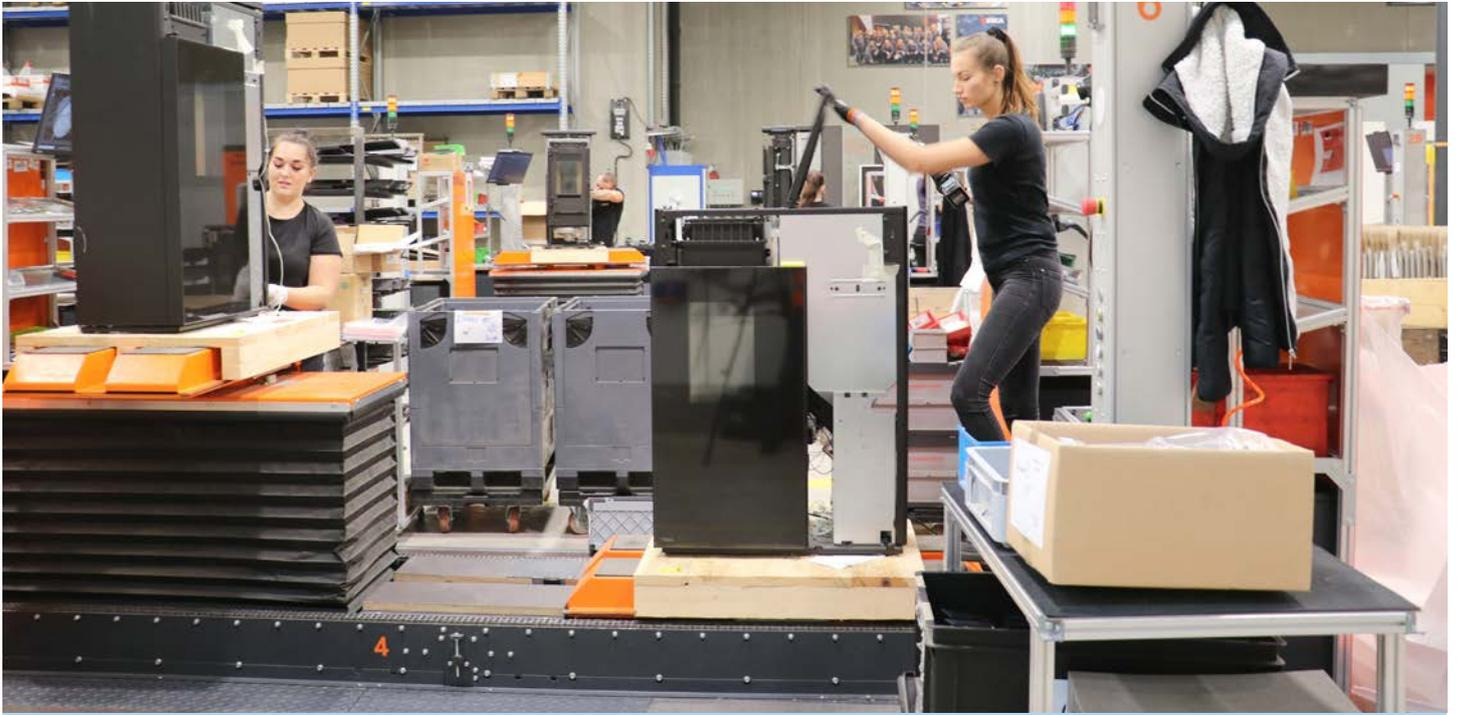
Una línea de montaje contiene seis módulos, cada uno con dos mesas de elevación. Estas se desplazan a 2 cm de altura sobre el transportador de cadena de la estación. A continuación, el empleado puede levantar, girar y hacer girar la mesa, así como colocar piezas mecánicas o electrónicas. Al final, la mesa se lleva a la posición de enclavamiento. Pulsando un botón, vuelve a bajar por la cadena y se pone en marcha.
