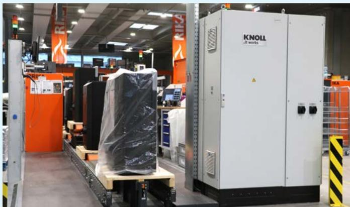
100-Prozent-Kontrolle: An der letzten Station in der Montagelinie werden alle Komponenten eines Ofens durchgecheckt.
