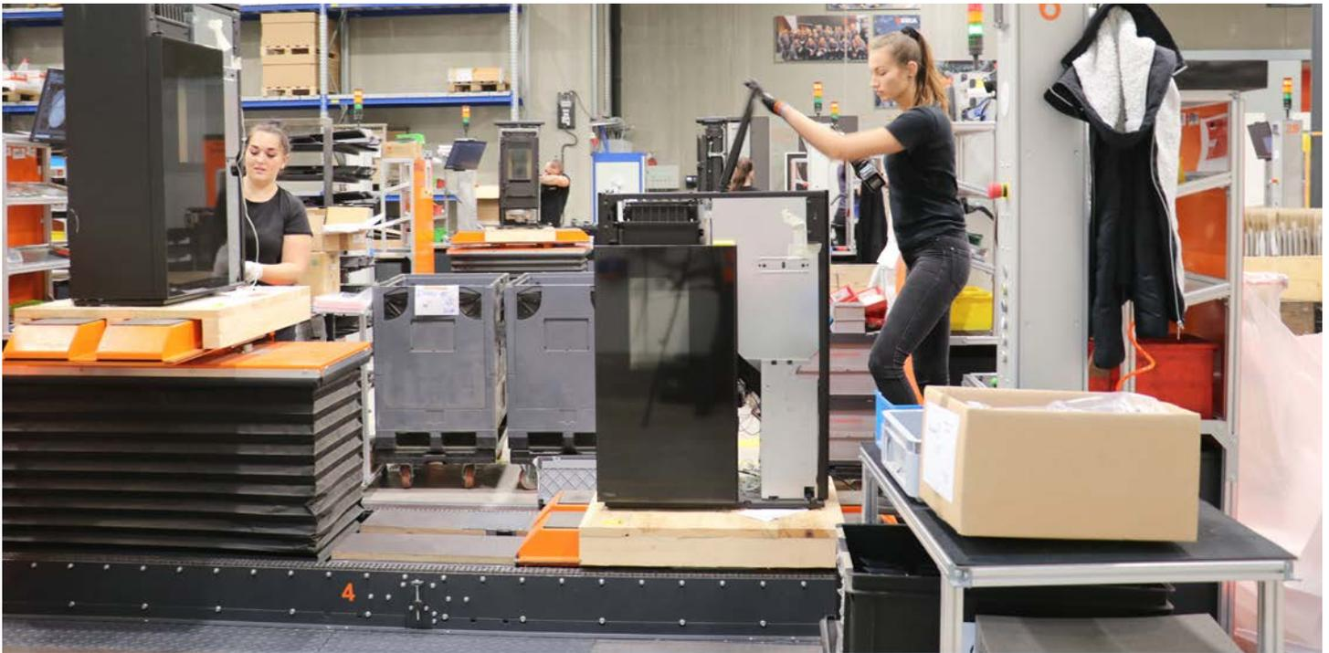
Eine Montagelinie enthält sechs Module mit jeweils zwei Hubtischen. Diese fahren an der Station 2 cm hoch über den Kettenförderer. Dann kann die Mitarbeiterin den Tisch heben, drehen und schwenken, mechanische Teile oder Elektronik anbauen. Am Ende wird der Tisch in die Einrastposition gebracht. Auf Knopfdruck fährt er wieder runter auf die Kette und wird weitergetaktet.
