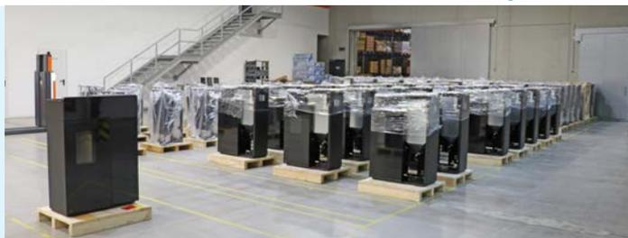
In der Pufferzone werden morgens die benötigten Grundkörper bereitgestellt. Auch die fertig montierten Öfen werden dort zwischenlagert.
