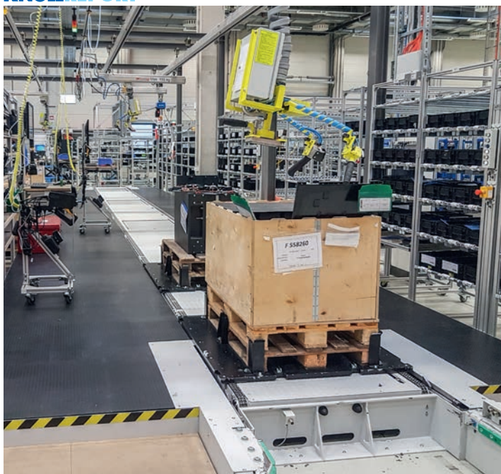
BMZ monte des batteries lithium-ion de poids important à l'aide des systèmes de transport KNOLL des type TS-S et TS-G.
