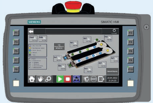
Vue d'ensemble de l'installation avec l'état des postes de travail
