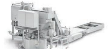
Transportador con trituradora de virutas, estación de reelevación RKR y equipo para aumentar la presión DHS
