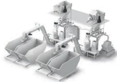
System zur Späneaufbereitung
