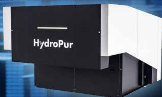
モジュラーシステムで構成されたシステムは、短納期が可能で価格/性能バランスも魅力的です。私たちはHydroPurのさらなる開発を行い、サイズと性能がお客様固有の要件にさらに適合するようにしました。2025年から、金属切削加工用のフィルターシステムが4種類のサイズで提供される予定です。さらに、真空サポート、フィルターフリース、エンドレスベルトの選択肢もあります。サイズと装備に応じて、フィルターは毎分250~1,500 Lの冷却潤滑剤を洗浄します。
