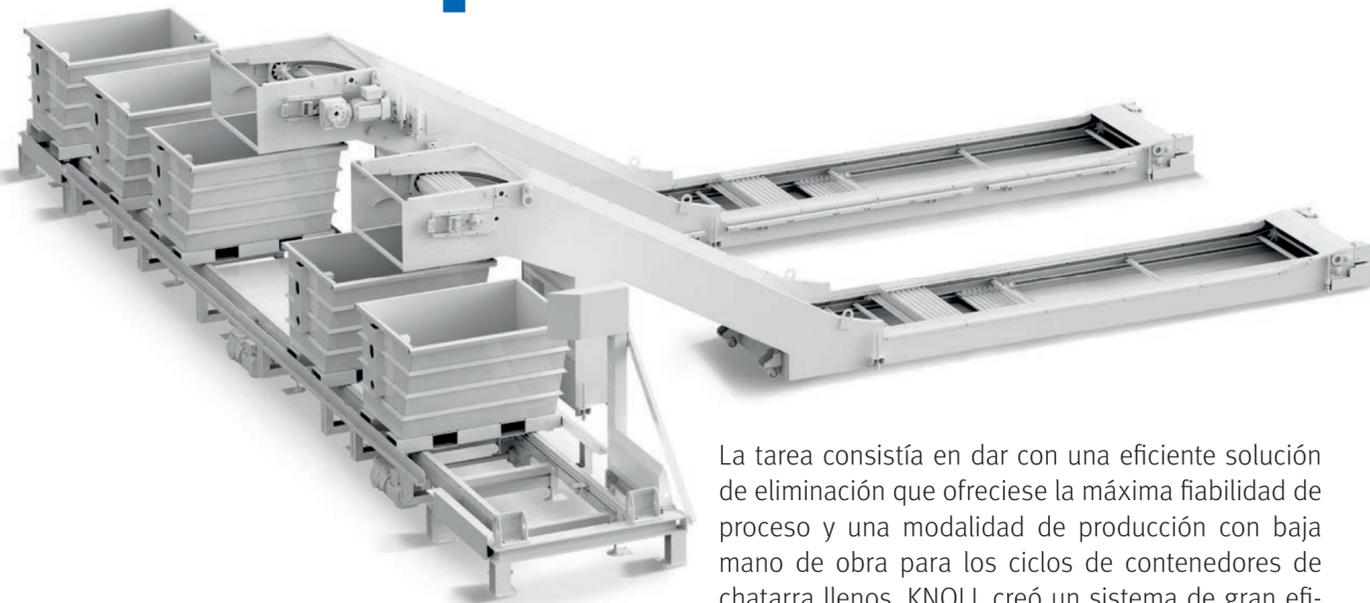
La tarea consistía en dar con una eficiente solución de eliminación que ofreciese la máxima fiabilidad de proceso y una modalidad de producción con baja mano de obra para los ciclos de contenedores de chatarra llenos. KNOLL creó un sistema de gran eficiencia que combinaba un transportador de placas y un sistema de transporte automático.
