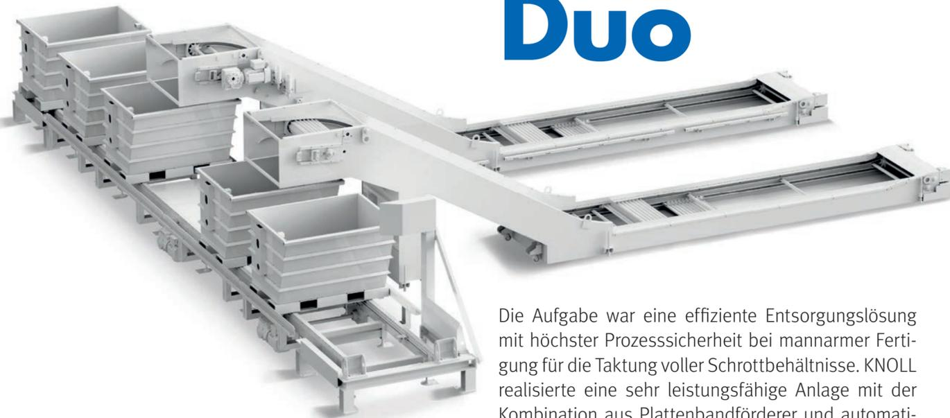
Die Aufgabe war eine effiziente Entsorgungslösung mit höchster Prozesssicherheit bei mannarmer Fertigung für die Taktung voller Schrottbehältnisse. KNOLL realisierte eine sehr leistungsfähige Anlage mit der Kombination aus Plattenbandförderer und automatischem Transportsystem.
