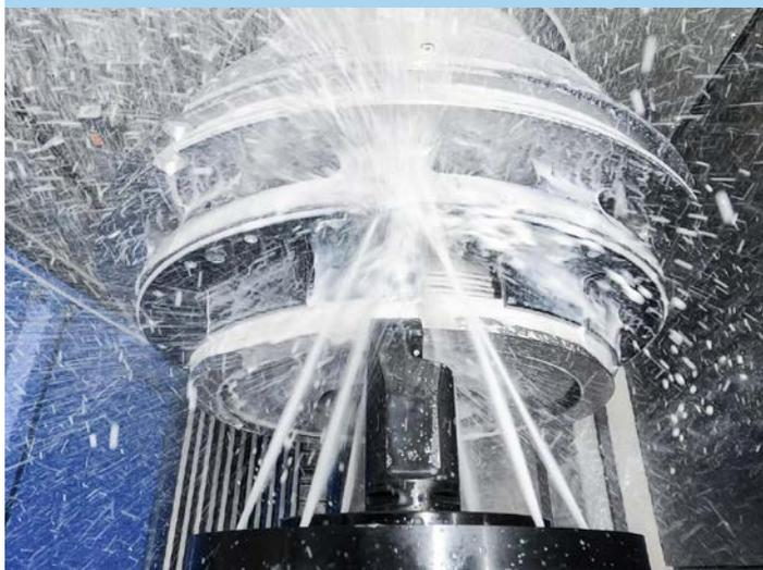
L'usinage de l'alliage à base de nickel Inconel 718 impose des contraintes élevées aux machines, aux outils et au lubrifiant réfrigérant.
