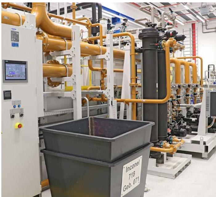
Un élément important du nouveau système de fabrication chez MTU : le système de refroidissement centralisé fourni par KNOLL. Il prend en charge le nettoyage, l'équilibrage de la température et le remplissage du fluide.
