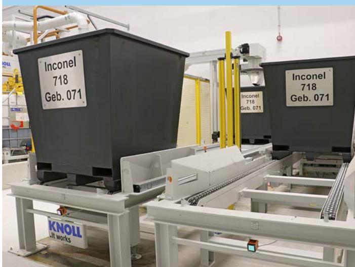
À l'extrémité du racleur à boues, les copeaux d'inconel sont transportés via une goulotte pivotante dans les bacs spéciaux (en arrière-plan). Conçu pour accueillir sept bacs, le poste de stockage temporaire des bacs de collecte permet un fonctionnement sans opérateur le week-end.
