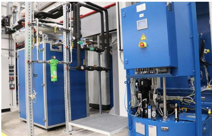
Les tours et fraiseuses du nouveau système de fabrication de MTU sont tous équipés d'un dispositif haute pression (à gauche) et d'une station de pompage de refoulement avec broyeur (à droite), respectivement fournis par KNOLL Maschinenbau.
