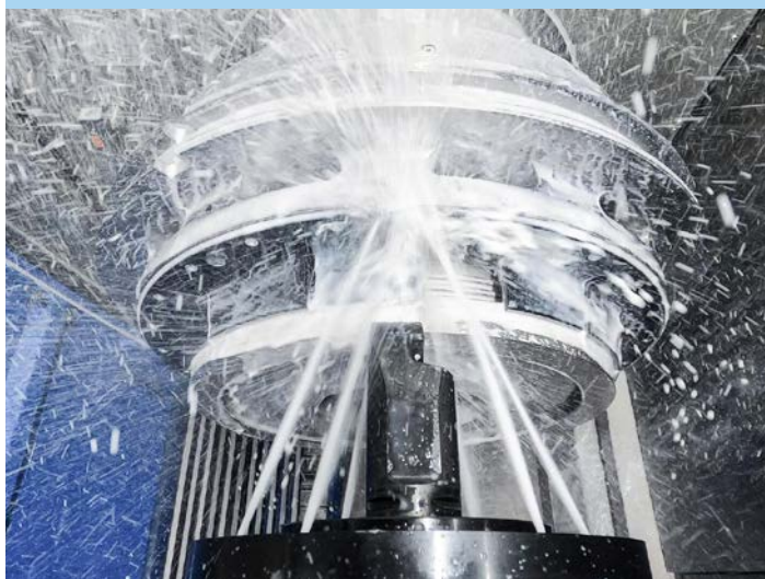
Die Zerspänung der nickelbasierten Legierung Inconel 718 stellt hohe Anforderungen an Maschine, Werkzeug und KSS.
