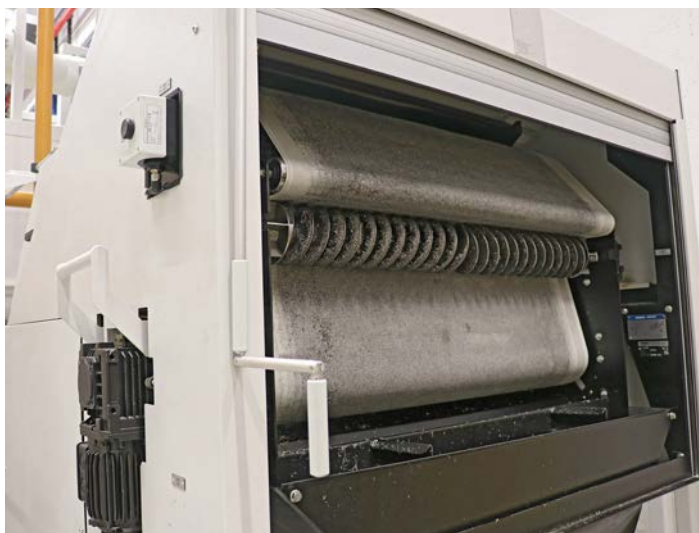
Der KNOLL Vakuumfilter VL1000 reinigt das rückgespülte Medium.
