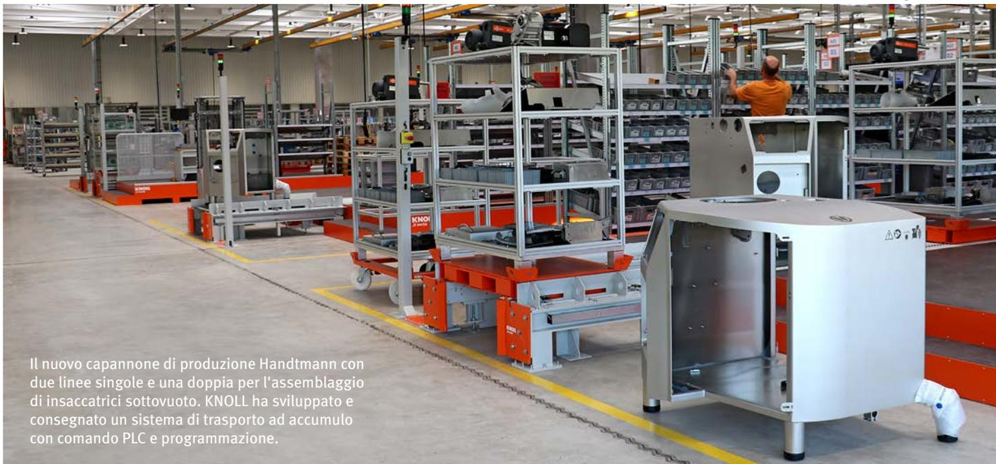
Il nuovo capannone di produzione Handtmann con due linee singole e una doppia per l'assemblaggio di insaccatrici sottovuoto. KNOLL ha sviluppato e consegnato un sistema di trasporto ad accumulo con comando PLC e programmazione.
