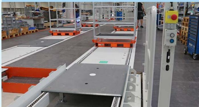
Un elemento importante del sistema di trasporto è rappresentato dalla piattaforma portante, configurata da KNOLL in modo da poter appoggiare tutti i telai della macchina da trasportare.
