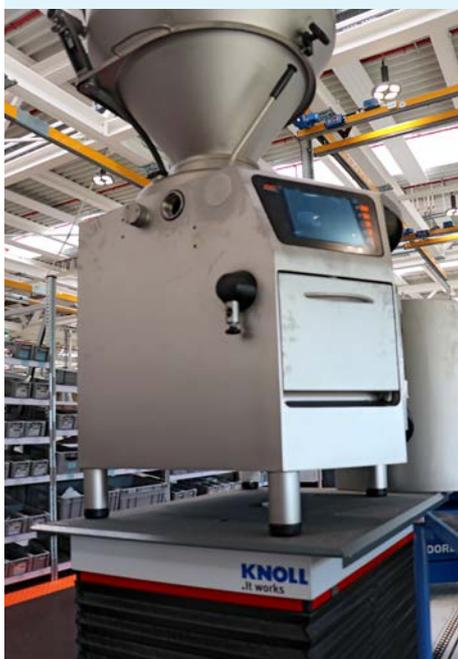
Dans chaque cycle est intégrée une table élévatrice avec laquelle le monteur peut amener le bâti de la machine à la hauteur ergonomique qui lui convient.
