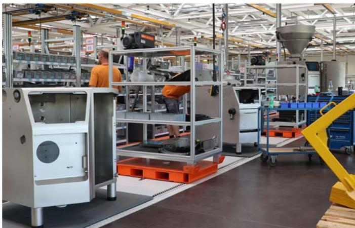
Des plaques de transport avec bâtis de machines et des chariots servants sont disposés en alternance sur la section de transport.
