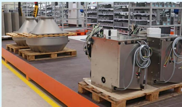
Les pièces de grande taille et les éléments prémontés se trouvent sur l'un des côtés du tapis de transport. Sur l'autre côté (que l'on voit en arrière-plan), il y a des rayonnages Kanban contenant les petites pièces.
