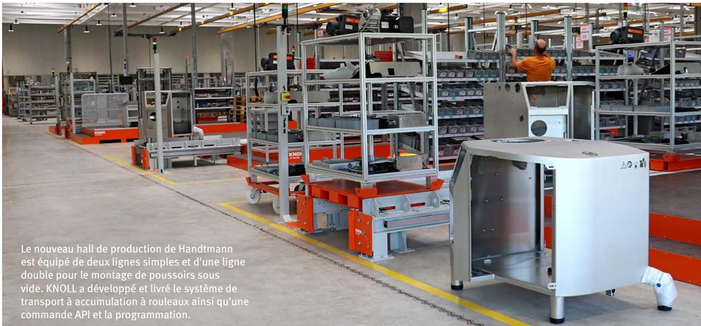
Le nouveau hall de production de Handtmann est équipé de deux lignes simples et d'une ligne double pour le montage de pousoirs sous vide. KNOLL a développé et livré le système de transport à accumulation à rouleaux ainsi qu'une commande API et la programmation.
