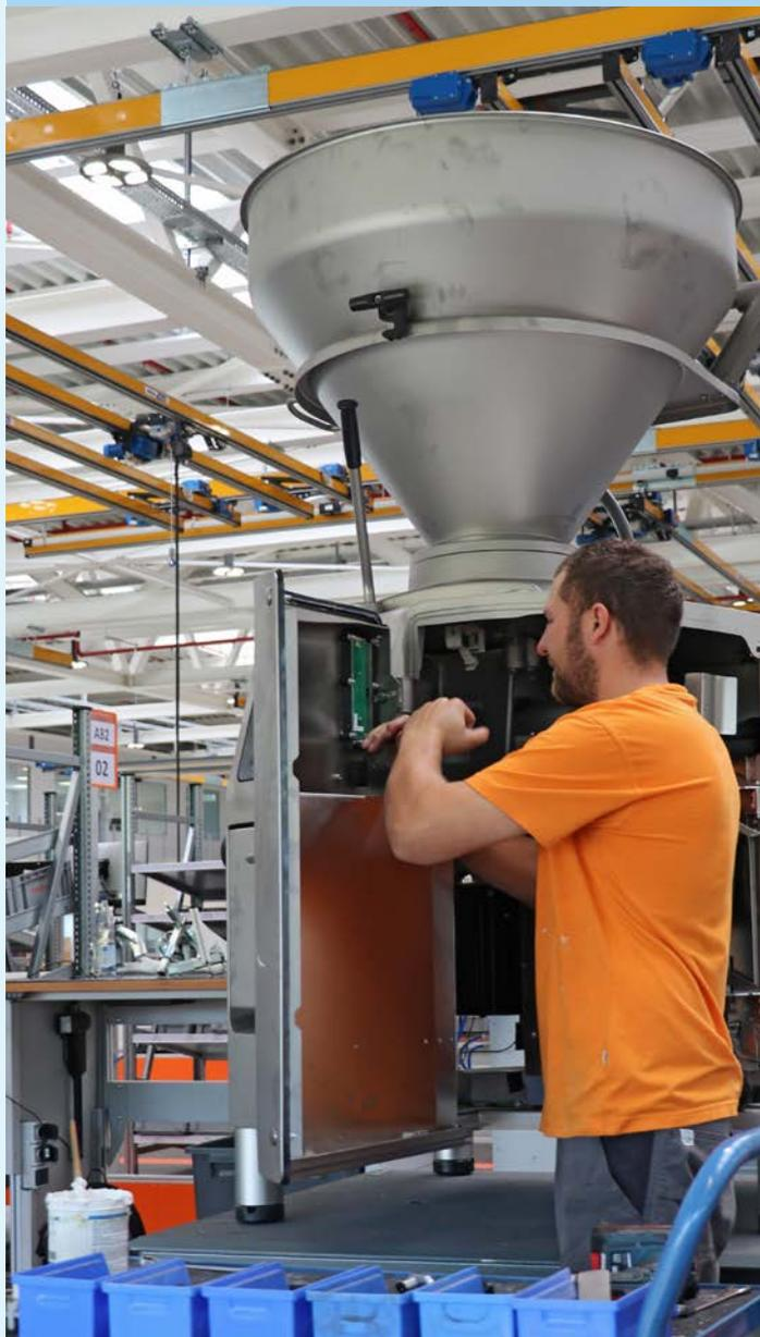
Les cycles 1 et 2 sont réservés au montage mécanique, l'installation électrique a lieu dans les cycles 3 et 4 (sur la photo).
