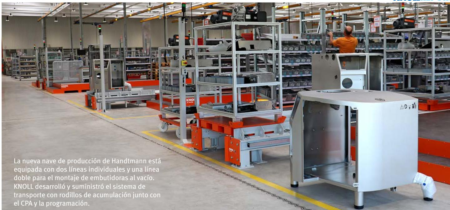
La nueva nave de producción de Handtmann está equipada con dos líneas individuales y una línea doble para el montaje de embudidoras al vacío. KNOLL desarrolló y suministró el sistema de transporte con rodillos de acumulación junto con el CPA y la programación.
