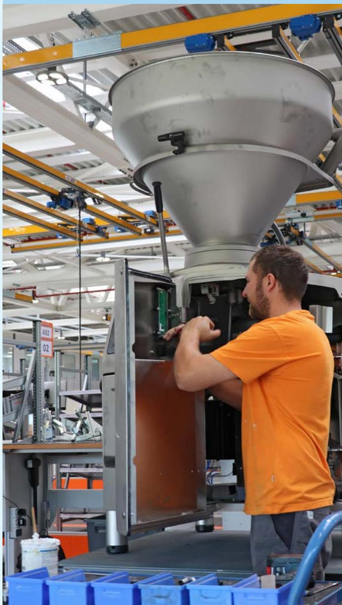
Los ciclos 1 y 2 están reservados para el montaje mecánico, mientras que en los ciclos 3 y 4 (en la imagen), se realiza la instalación eléctrica.
