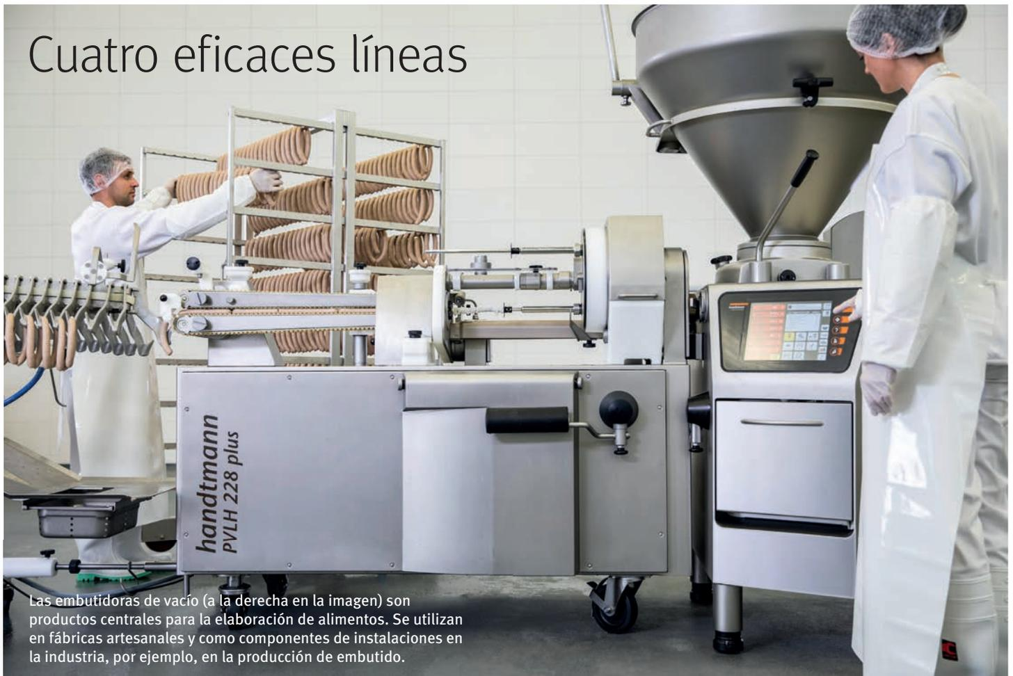
Las embutidoras de vacío (a la derecha en la imagen) son productos centrales para la elaboración de alimentos. Se utilizan en fábricas artesanales y como componentes de instalaciones en la industria, por ejemplo, en la producción de embutido.
