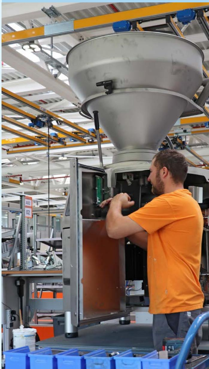
Die Takte 1 und 2 sind der mechanischen Montage vorbehalten, in den Takten 3 und 4 (im Bild) findet die Elektroinstallation statt.
