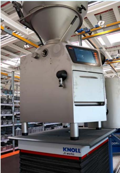
In jeden Takt ist ein Hubtisch integriert, mit dem der Monteur das Maschinengestell in eine individuelle, ergonomische Höhe fahren kann.
