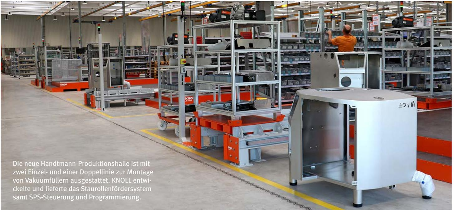
Die neue Handmann-Produktionshalle ist mit zwei Einzel- und einer Doppellinie zur Montage von Vakuumfüllern ausgestattet. KNOLL entwickelte und lieferte das Staurollenfördersystem samt SPS-Steuerung und Programmierung.
