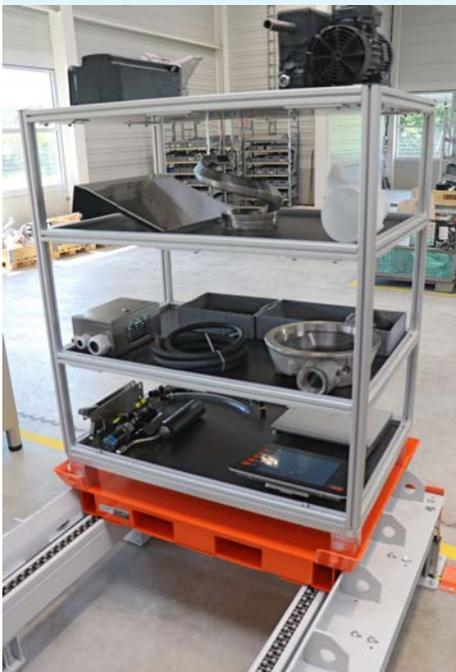
Eine essentielle Funktion übernehmen die sogenannten Set-Wagen, die für jede zu montierende Maschine auftragsspezifische Komponenten mit-fördern.
